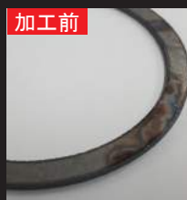
SPC 1.6t \phi 70 mm レーザーカット
