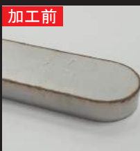
SUS 4.0t 50×10 mm レーザーカット
