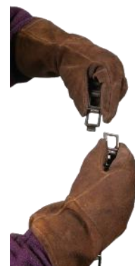
Le maglie della catena possono essere regolate facilmente per ottenere diversi diametri dei tubi.
