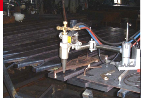
IK-82 M300 используется для резки профиля
