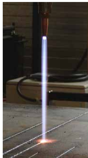
Potente flusso di ossigeno da taglio da un ugello divergente: Foto scattata del test prestazionale interno KOIKE. Punta ugello a 275 mm sopra la lamiera, ugello 106-D7#0.
