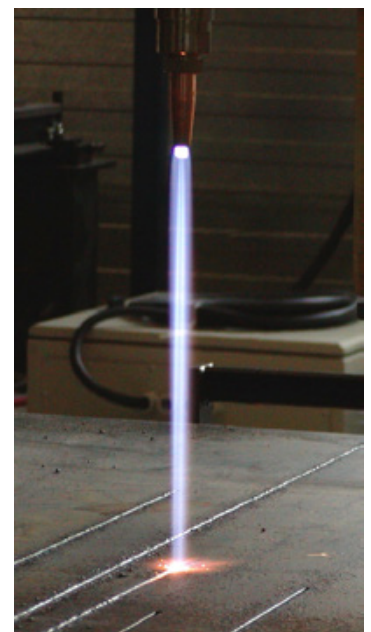
Starker Gasstrom des Schneidsauerstoffstrahls aus einer Koike Düse mit hoher Stahldivergenz: Aufnahme während eines Leistungstests im hauseigenen KOIKE Testlabor. Düse 275mm oberhalb der Platte. Düse 106-D7#0
