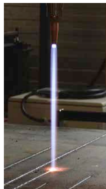
KOIKE high speed D nozzle gemaakt voor de beste snijkwaliteit. Test bij Koike op 275 mm hoogte vanaf de plaat. Nozzle: 106-D7#0.
