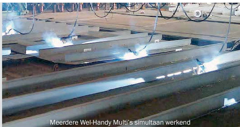
De besturing is geschikt voor pendel en hechtlas toepassingen
