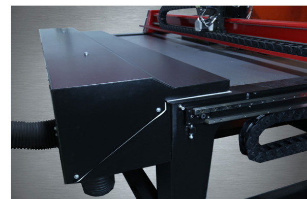
Plenum voor afzuiging met een filtersysteem
