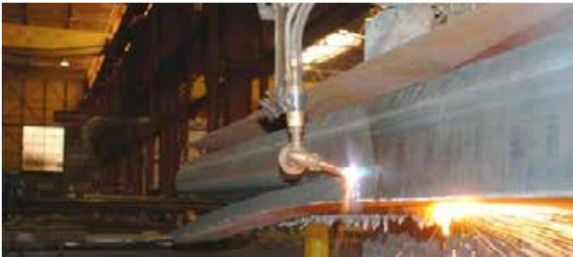
Torche S100 avec option glissière verticale longue et tête orientable
