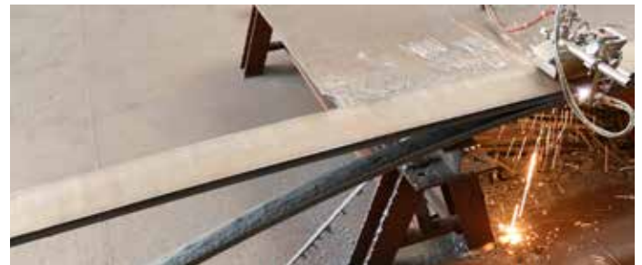
Torche S100 avec option glissière verticale longue et guide bord de tôle
