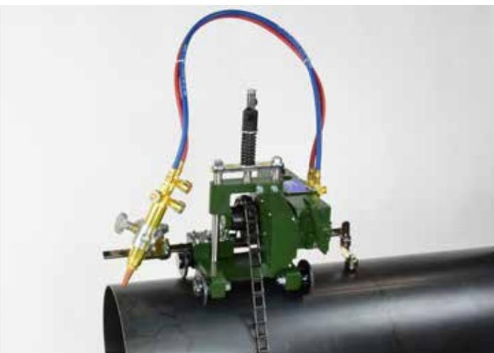
Le rail de guidage en option permet une précision de coupe élevée, en particulier appropriée pour les gros diamètres de tube. Chaque rail de guidage est doté de maillons de chaîne supplémentaires adaptés aux diamètres.
