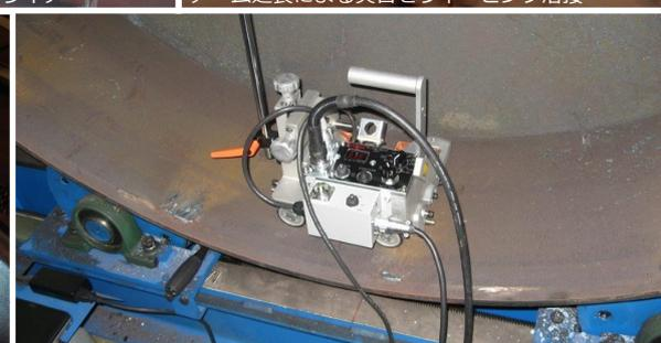
角度センサーを内蔵しターニングロールと連動するタンク溶接
