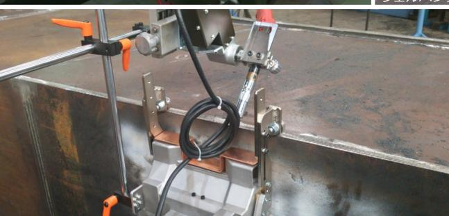
トーチ延長アームとウィーピングユニットによる曲面コーナー溶接
