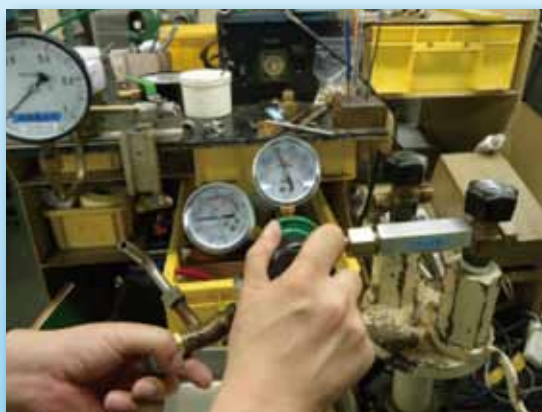
調整器の圧力上昇検査
