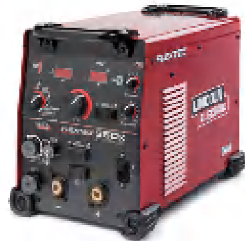
FLEXTEC 350X 溶接電流300Aで利用率100%の中出力溶接機。 インバータ電源により重量35kgを実現。
